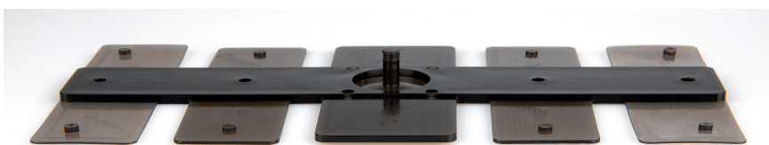
Bild 4. Stufenplatte mit vier unterschiedlichen Wanddicken. Der mittlere Steg ist 3 mm dick. Die Seitenarme haben Wanddicken von 2, 1 und 0,5 mm, wobei sich die dünnsten Bereiche am Fließwegende befinden. © Engel
